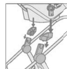
Adaptador CLIP / AIR.SAFE: Con el adaptador CLIP / AIR.SAFE el portabebé CONCORD AIR.SAFE se adapta también a todas las sillas de paseo con puntos de fijación Maxi-Cosi
