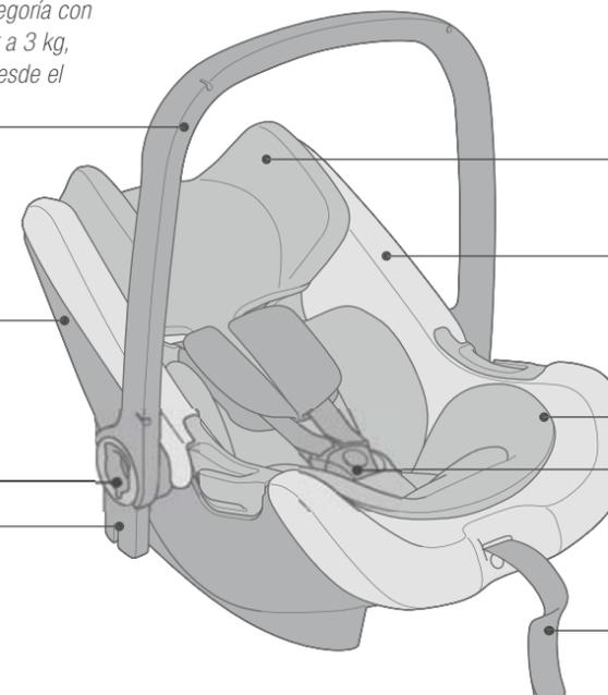
Sencillo ajuste de la altura del reposacabezas, con ajuste simultáneo y automático del cinturón
