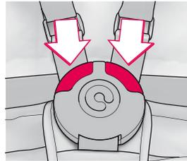
Para abrir el sistema del cinturón apriete el botón situado en el centro del cierre del cinturón hasta que los adaptadores del cierre salten.
