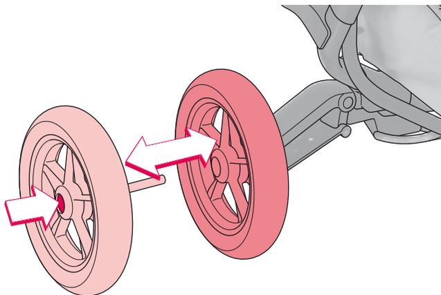
Para desmontar la rueda trasera mantenga el botón de presión (19) apretado y saque la rueda del eje.
