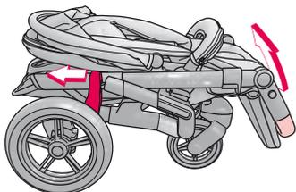
Para plegar el CONCORD NEO coloque en primer lugar el ángulo del bastidor del asiento (03) en la posición P (véase AJUSTE DEL ÁNGULO DEL ASIENTO).
