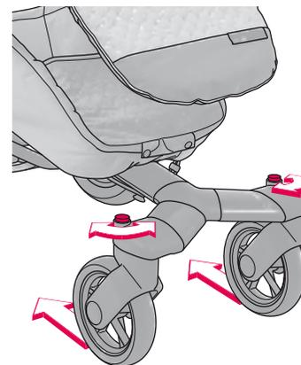
Para fijar las ruedas delanteras del CONCORD NEO, dirija las ruedas hacia atrás y gire los cabezales de retención (09) de fuera hacia dentro.
