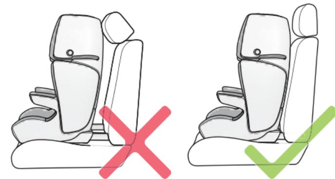
En los vehículos con reposacabezas de serie se puede conseguir un mejor montaje de la silla regulando o desmontando ese reposacabezas. El reposacabezas deberá montarse de nuevo en su posición correcta cuando viaje un adulto.
