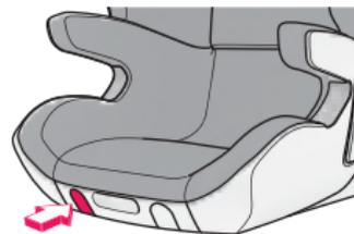
Para usar la regulación de inclinación del CONCORD TRANSFORMER pulsar el botón para inclinación de la silla (04) en el borde delantero de la silla.
