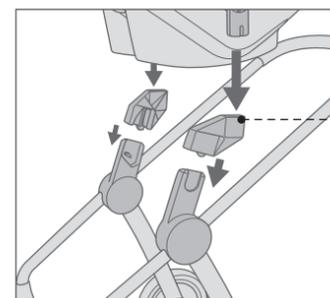
Con l'adattatore CLIP / AIR.SAFE l'ovetto CONCORD AIR.SAFE si adatta anche ai punti di fissaggio Maxi-Cosi.
