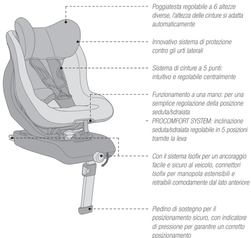
Poggiatesta regolabile a 6 altezze diverse, l'altezza delle cinture si adatta automaticamente
