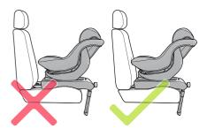
Presione el botón de mando (09) hacia afuera y ajuste el pie de soporte (10) de modo que quede bien apoyado sobre el suelo y el indicador de seguridad sea de color VERDE.
