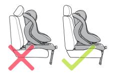
Presione el botón de mando (09) hacia afuera y ajuste el pie de soporte (10) de modo que quede bien apoyado sobre el suelo y el indicador de seguridad sea de color VERDE.
