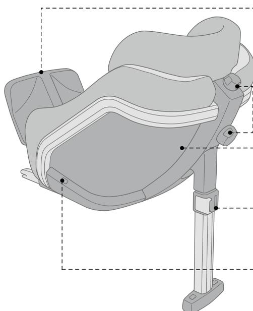
AYUDA DE MONTAJE AUTOMÁTICO reposapiés amortiguado, con adaptación automática al asiento del vehículo
