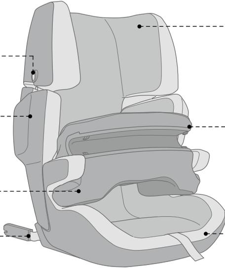
VARIOSIZE SYSTEM: la altura del reposacabezas y la altura y anchura de los protectores de la zona de los hombros se pueden ajustar gradualmente al mismo tiempo con un botón de acción neumática
