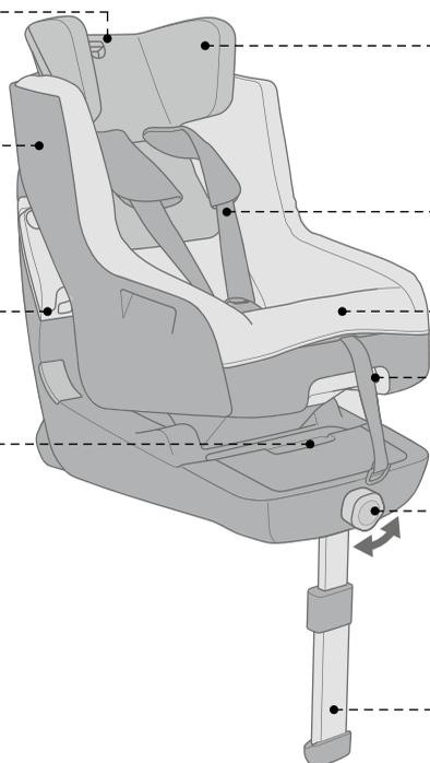
VARIOSIZE SYSTEM: reposacabezas con ajuste de altura y anchura, con ajuste simultáneo y automático del cinturón
