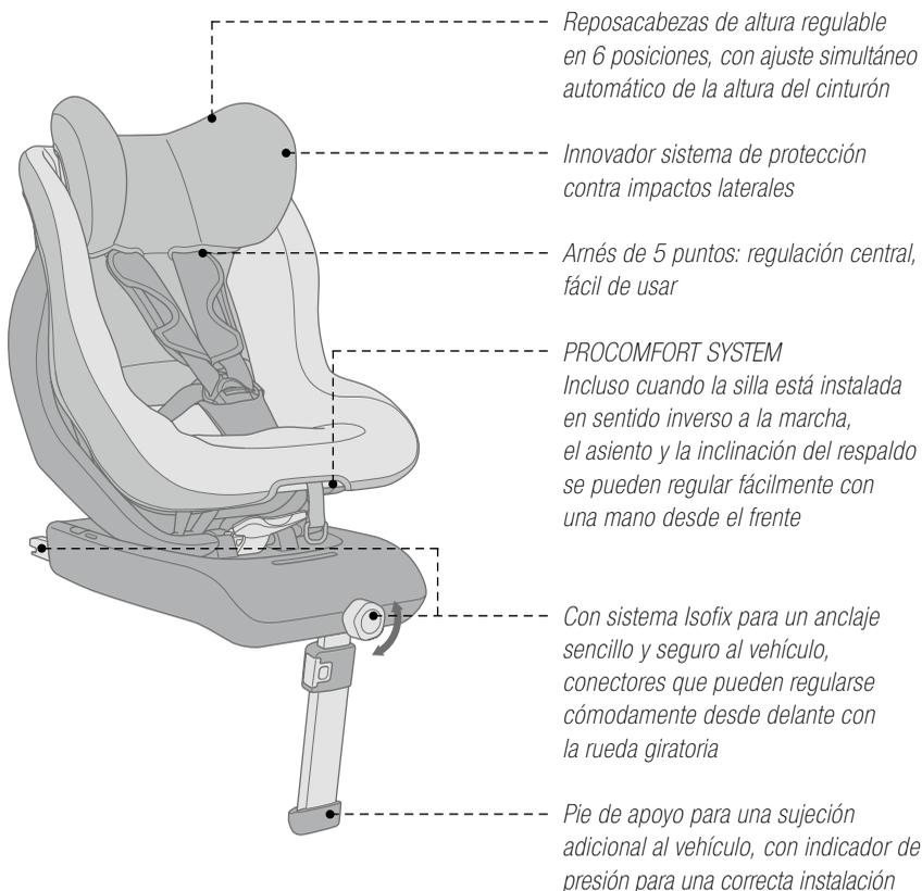
Reposacabezas de altura regulable en 6 posiciones, con ajuste simultáneo automático de la altura del cinturón
