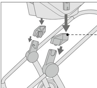
Con el adaptador CLIP / AIR.SAFE el portabebés CONCORD AIR.SAFE se acopla también a los puntos de sujeción del Maxi-Cosi.
