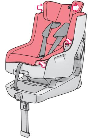
Fixieren Sie den Bezug mit Hilfe der Druckknöpfe am CONCORD ABSORBER.
