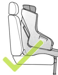
Klappen Sie den Stützfuß (11) an der Unterseite des CONCORD ABSORBER nach vorn, bis er einrastet.
