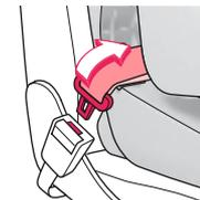
Öffnen Sie das Gurtschloss des Dreipunktgurtes und führen Sie diesen zwischen Sitzteil und Basis des CONCORD ABSORBER hindurch.
