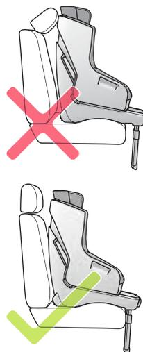
Desplegar el pie de soporte (11) en la parte inferior del CONCORD ABSORBER hacia delante hasta que encaje.
