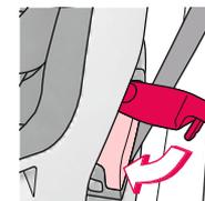
Poussez le bouton de commande (10) vers l'extérieur et réglez le socle (11) de sorte que celui-ci repose bien au sol et que le voyant de sécurité soit VERT.
