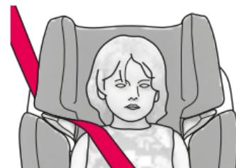
Il passante della cintura per le spalle (07) deve trovarsi leggermente al di sopra del limite della spalla. Al contempo, la cintura per le spalle deve scorrere centralmente tra il collo e il lato esterno della spalla.
