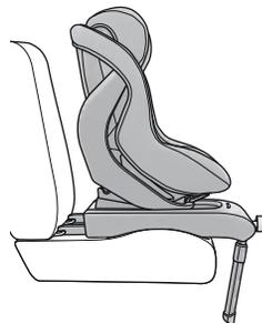
Poussez la base vers l'arrière sur les supports ISOFIX jusqu'à ce que les mécanismes de fermeture des deux adaptateurs ISOFIX (15) s'enclenchent de manière audible et que les voyants de sécurité (14) des deux côtés soient verts !
