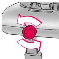
Ruotare il pulsante SISTEMA ISOFIX (08) sul lato anteriore della base I-Size del seggiolino CONCORD ULTIMAX verso sinistra, e spostare la base in avanti.
