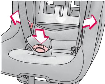
**Compruebe que todos los cierres están cerrados y que todos los anclajes estén correctamente fijados.**
