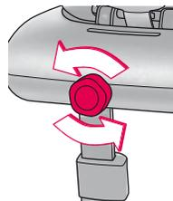
Ruotare il pulsante SISTEMA ISOFIX (08) sul lato anteriore della base I-Size del seggiolino CONCORD ULTIMAX verso sinistra, finché gli adattatori ISOFIX (15) sul retro del seggiolino non hanno raggiunto la posizione finale.
