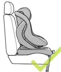
Desloque o botão de controlo (09) do ajuste da base de protecção superior para fora e ajuste o pé de apoio (10) de modo que este assente fixamente no chão e que a indicação de segurança fique VERDE.
