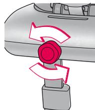
Gire el Pomo ISOFIX SYSTEM (08) en la parte delantera de la base del CONCORD ULTIMAX hacia la izquierda hasta que el adaptador de ISOFIX (15) esté completamente desplegado en la parte posterior.
