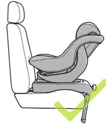
Desloque o botão de controlo (09) do ajuste da base de proteção superior para fora e ajuste o pé de apoio (10) de modo que este assente fixamente no chão e que a indicação de segurança fique VERDE.
