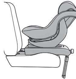
Schieben Sie die Basis nach hinten auf die ISOFIX-Aufnahmen, bis die Verschlussmechanismen beider ISOFIX-Adapter (15) hörbar eingerastet und die Sicherheitsanzeigen (14) auf beiden Seiten der Basis grün sind!
