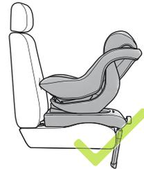
Schieben Sie den Bedienknopf (09) der oberen Stützfuss-Verstellung nach außen und stellen Sie den Stützfuß (10) so ein, dass er fest auf dem Boden aufsteht und die Sicherheitsanzeige GRÜN ist. Wenn notwendig muss zusätzlich die untere Verstellung des Stützfuß genutzt werden.
