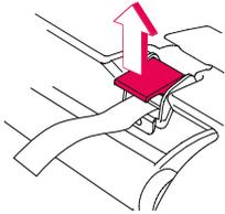
En la parte delantera de la carcasa bajo la funda se encuentra el ajustador central (03) para apretar el cinturón central (04). Afloje el ajustador central (03) presionando hacia arriba la tapa del ajustador central y empuje el cinturón hacia adelante (sin tirar del relleno).
