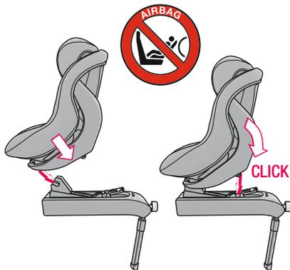
Empuje a continuación la carcasa del asiento hacia adelante hasta que el sistema de inmovilización (11) en la base del I-Size encaje con un „clic“ y el indicador de seguridad (07) sobre el lado superior esté verde.
