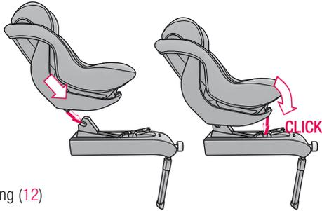
Klappen Sie anschließend die Sitzschale nach vorn, bis die vordere Sitzschalen-Arretierung (11) an der I-Size-Basis hörbar einrastet und die Sicherheitsanzeige (07) auf der Oberseite grün ist.
