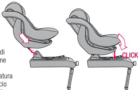
Piegare poi il guscio in avanti, finché il bloccaggio guscio anteriore (11) non scatta in posizione nella base I-Size mostrando l'area verde di sicurezza (07) sul lato superiore.
