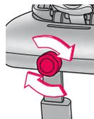
Draai de bedieningsknop ISOFIX SYSTEEM (08) zo lang naar rechts tot de CONCORD ULTIMAX zo dicht/vlak mogelijk tegen de rugleuning van de autostoel ligt.
