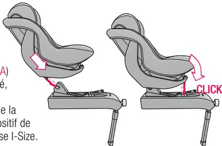
Rabattez finalement la coque du siège vers l'avant jusqu'à ce que le dispositif de blocage avant (11) de la base I-Size s'enclenche de manière audible et que les voyants de sécurité (07) sur la face supérieure soient verts.
