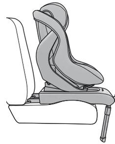
Schieben Sie die Basis nach hinten auf die ISOFIX-Aufnahmen, bis die Verschlussmechanismen beider ISOFIX-Adapter (15) hörbar eingerastet und die Sicherheitsanzeigen (14) auf beiden Seiten der Basis grün sind!
