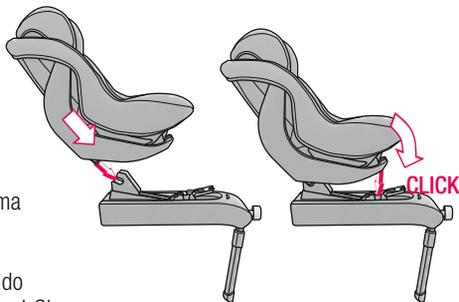
Em seguida, vire o fundo do assento para a frente, até o bloqueio dianteiro do fundo do assento (11) encaixar com um estalido na base I-Size e a indicação de segurança (07) na parte superior ficar verde.
