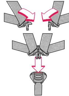
Coloque al niño bien en la superficie del asiento. Pase el cinturón pélvico/diagonal y el cinturón central por delante del niño y coloque el cierre.
