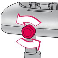
Tournez le bouton de commande du SYSTEME ISOFIX (08) sur la face avant de la base I-Size du CONCORD ULTIMAX vers la gauche et déplacez la base vers l'avant.
