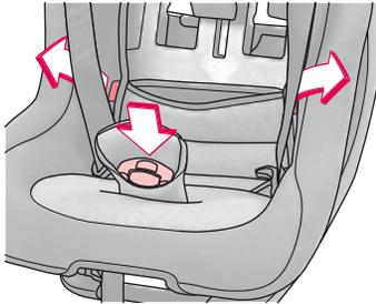
**Tarkasta, että kaikki lukot ovat kiinni ja kaikki ankkuroinnit oikein kiinnitetty.**
