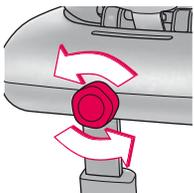
Käännä CONCORD ULTIMAX I-Size-telakan etupuolella olevaa ISOFIX JÄRJESTELMÄN käyttönuppia (08) vasemmalle ja liikuta telakkaa eteenpäin.
