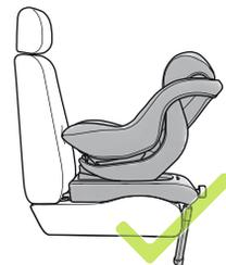
Poussez le bouton de commande (09) du système de réglage supérieur du socle vers l'extérieur et réglez le socle (10) de sorte que celui-ci repose bien au sol et que le voyant de sécurité soit VERT. Si nécessaire, le système de réglage inférieur du socle doit également être utilisé.
