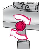
Ruotare verso destra il pulsante SISTEMA ISOFIX (08), finché il CONCORD ULTIMAX non aderisce il più possibile allo schienale del sedile dell'auto.
