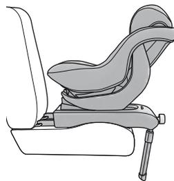
Poussez la base vers l'arrière sur les supports ISOFIX jusqu'à ce que les mécanismes de fermeture des deux adaptateurs ISOFIX (15) s'enclenchent de manière audible et que les voyants de sécurité (14) des deux côtés soient verts !
