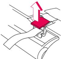
Forrest under sædeskålen under betrækket sidder den centrale indstilling (03), der holder centralsele (04). Løsn den centrale indstilling (03) ved at trykke dens afdækning op og trække seleterne fremad (træk ikke i selepuderne).
