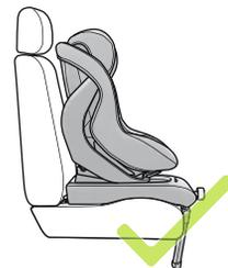
Skyv betjeningsknappen (09) til den øvre støttefotjusteringen utover og still støttefoten (10) inn slik, at den står fast på bakken og sikkerhetsindikeringen er GRØNN. Om nødvendig må en i tillegg benytte den nedre justeringen av støttefoten.
