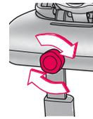
Drehen Sie den Bedienknopf ISOFIX SYSTEM (08) so lang nach rechts, bis der CONCORD ULTIMAX möglichst dicht/bündig an der Rückenlehne des Autositzes anliegt.
