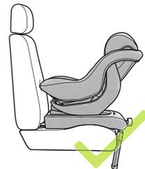
Presione hacia afuera el botón de mando (09) de la regulación del pie de soporte y coloque el pie de soporte (10) de modo que quede bien enganchado sobre el suelo y el indicador de seguridad sea de color VERDE.
