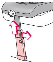
Pressione os botões de desbloqueio do ISOFIX SYSTEM (13) do lado esquerdo e direito da base, de forma que os adaptadores ISOFIX (15) se soltem dos encaixes e que a base salte para a frente.
