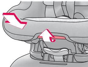
El desbloqueo del sistema de inmovilización de la carcasa del asiento (06) se encuentra delante por debajo de la carcasa del asiento sobre el lado superior de la base I-Size.
