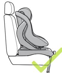
Poussez le bouton de commande (09) du système de réglage supérieur du socle vers l'extérieur et réglez le socle (10) de sorte que celui-ci repose bien au sol et que le voyant de sécurité soit VERT. Si nécessaire, le système de réglage inférieur du socle doit également être utilisé. Relâchez le bouton de commande (09) et enclenchez le socle.
