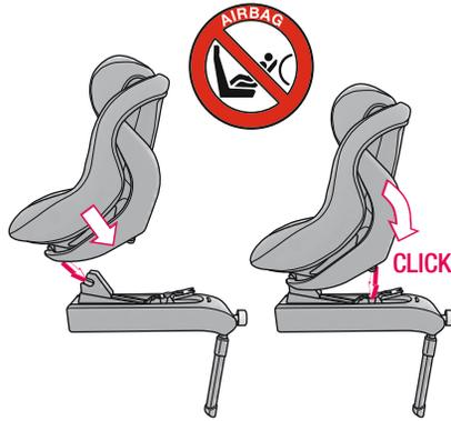
Em seguida, vire o fundo do assento para a frente, até o bloqueio dianteiro do fundo do assento (11) encaixar com um estalido na base I-Size e a indicação de segurança (07) na parte superior ficar verde.
