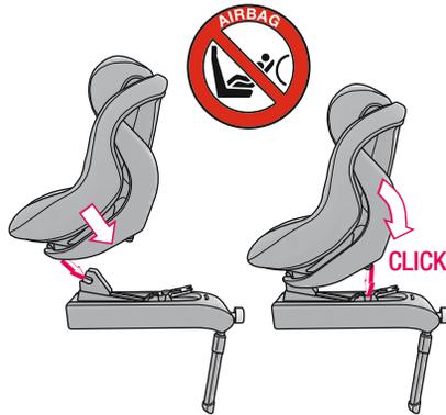
Klappen Sie anschließend die Sitzschale nach vorn, bis die vordere Sitzschalen-Arretierung (11) an der I-Size-Basis hörbar einrastet und die Sicherheitsanzeige (07) auf der Oberseite grün ist.
