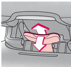
Le dispositif de déverrouillage du système de blocage de la coque du siège (06) se trouve à l'avant, sous la coque du siège, sur la partie supérieure de la base I-Size.
