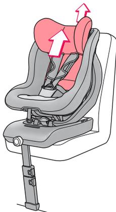
Il passante della cintura per le spalle deve trovarsi leggermente al di sopra del limite della spalla. Al contempo, la cintura per le spalle deve scorrere centralmente tra il collo e il lato esterno della spalla.
