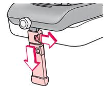
Lassen Sie den Bedienknopf (09) los und den Stützfuß einrasten.
