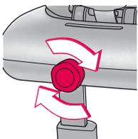
Drehen Sie den Bedienknopf ISOFIX SYSTEM (08) solange nach rechts, bis die ISOFIX-Adapter (15) vollständig eingefahren sind.
