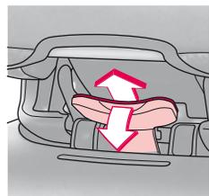
Åpningsmekanismen for låsen (06) til setedelen befinner seg foran på undersiden av seteunderlaget, på oversiden av I-Size-basis.
