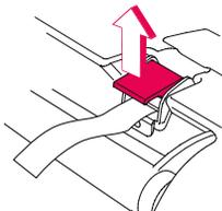
Sulla parte anteriore del guscio, sotto il rivestimento, è collocato il sistema di regolazione centrale (03), che permette di bloccare in posizione la cintura centrale (04). Allentare il sistema di regolazione centrale (03), e tenendo premuto verso l'alto il coperchio del sistema di regolazione centrale tirare le cinture in avanti (non afferrare le imbottiture delle cinture per tirare!).
