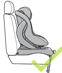
Skub betjeningsknappen (09) på den øverste støttefodjustering udad og indstil støttefoden (10) således, at den står fast på gulvet og sikkerhedsindikatoren er GRØN.
