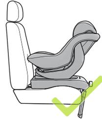
Työnnä ylemmän tukijalan säätöpainiketta (09) ulospäin ja säädä tukijalkaa (10) niin, että se on tukevasti runkoa vasten ja turvaimaisin on VIHREÄ. Tarvittaessa täytyy lisäksi käyttää myös tukijalan alemmaa säätöä.
