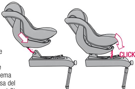
Empuje a continuación la carcasa del asiento hacia adelante hasta que el sistema de inmovilización (11) en la base del I-Size encaje con un „clic“ y el indicador de seguridad (07) sobre el lado superior esté verde.
