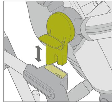
L'adaptateur TRAVEL SYSTEM permet un changement simple et rapide des composants TS.
