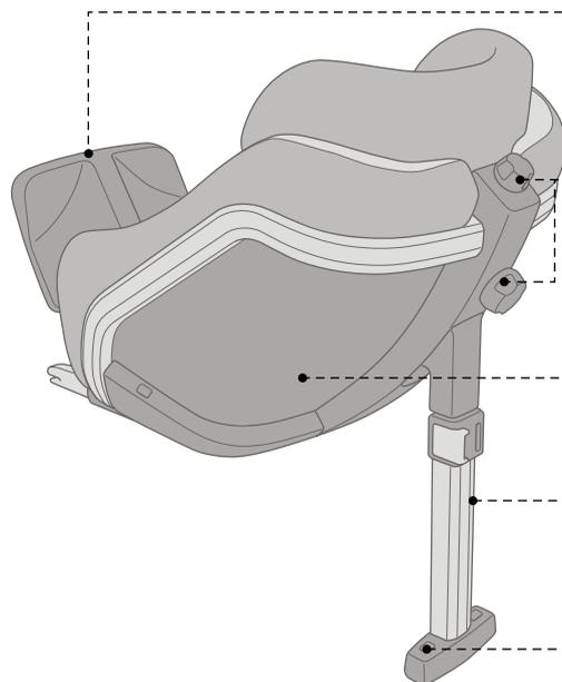
Automatische Einbau-Hilfe: gedämpfte Fußplatte mit automatischer Anpassung an den Fahrzeugsitz
