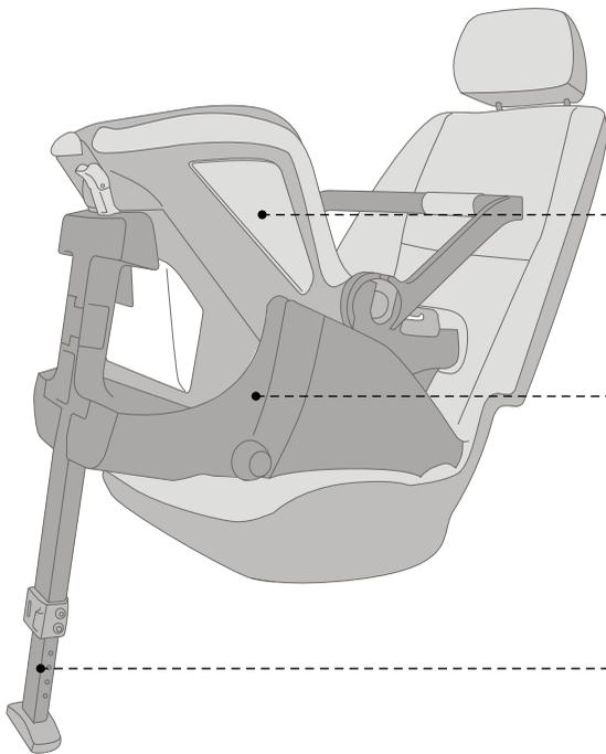
Side Impact Protector: diseño especial para absorber impactos laterales en combinación con el cabezal ajustable
