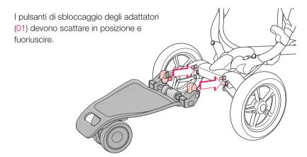
Controllare prima dell'utilizzo, che il montaggio sia stato eseguito correttamente, che i meccanismi di chiusura siano chiusi e che lo snodo centrale (05) sia bloccato.
