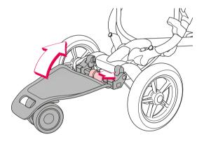
Fissare il CONCORD SLIDER con la cintura di sicurezza (03) precedentemente fissata al CONCORD NEO.
