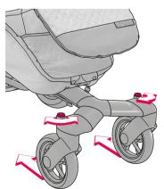
Per fissare le ruote anteriori del CONCORD NEO, orientare le ruote anteriori in senso inverso a quello di marcia e ruotare i pulsanti di arresto (09) dall'esterno verso l'interno.
