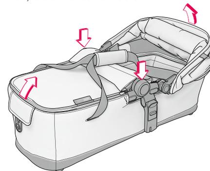
Ziehen Sie die Arretierungsgurte (01) nach oben heraus und verankern Sie diese an den dafür vorgesehenen Punkten auf der Unterseite. Klappen Sie die Adapter (04) des ProFix-Systems nach innen.
