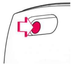
Размер сиденья CONCORD TRANSFORMER можно ступенчато отрегулировать (20 ступень) в зависимости от роста Вашего ребенка. Для регулировки сиденья CONCORD TRANSFORMER нажмите кнопку регулирования по росту (04) на задней стенке спинки и переместите подголовник (01) в нужное положение при нажатой кнопке (04). Когда Вы отпустите кнопку (04), сиденье CONCORD TRANSFORMER зафиксируется в текущем положении.
