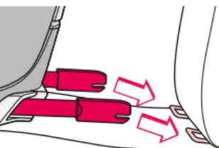
Оба адаптера TWINFIX (10) следует надвигать на крепления ISOFIX автомобиля до тех пор, пока не будет слышен щелчок фиксирующих механизмов.
